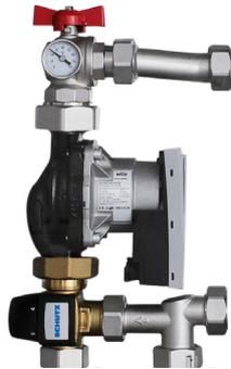
Kompakte, einbaufähig vormontierte Grundeinheit aus Messing, Pumpe Wilo Para 25/6 SC\*, 1½"-Einbaulänge 130 mm, 3-Wege-Mischventil mit Festwertregler, anschlussfertig verdrahtetem Maximal-Temperaturbegrenzer, einem sekundärseitigen Kugelhahn (Vorlauf) inkl. Thermometer. Anschluss primär- und sekundärseitig 1.
