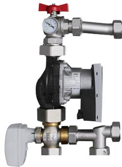
Kompakte, einbaufähig vormontierte Grundeinheit aus Messing, Pumpe Wilo Para 25/6 SC\*, 1½"-Einbaulänge 130 mm, 3-Wege-Mischventil zur Montage des Kleinventilantriebs 230 V, anschlussfertig verdrahtetem Maximal-Temperaturbegrenzer, einem sekundärseitigen Kugelhahn (Vorlauf) inkl. Thermometer. Anschluss primärund sekundärseitig 1. **Kleinventilantrieb und Kugelhahnset bitte separat disponieren.**
