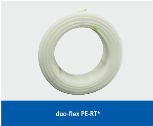
Los tubos de seguridad de plástico de cinco capas de polietileno no reticulado PE-RT se fabrican de acuerdo con la norma DIN 16833 y son estancos a la difusión de oxígeno según la norma DIN 4726. Todos los tubos duo-flex PE-RT son supervisados por el Süddeutsche Kunststoffzentrum SKZ Würzburg y disponen de certificación SKZ.
