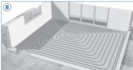
En la instalación en forma de serpentín (**figura B**) el tubo se dirige hacia el centro del circuito con el doble de paso. Después del bucle de inversión, el retorno del circuito debe colocarse entre los conductos de impulsión ya colocados hasta el colector del circuito.
