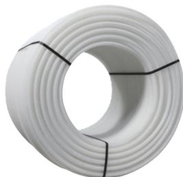
Tubo de seguridad de plástico de 5 capas, fabricado conforme a la norma DIN EN 15875, de polietileno reticulado PE-Xa según el proceso de peróxido con barrera contra la difusión de oxígeno.
