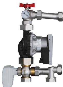
Kit compacto premontado y listo para instalar, compuesto de bomba Wilo Para 25/6 SC\* con conexiones 1 ½" y longitud de montaje 130 mm, válvula de 3 vías con rosca para el montaje de un servomotor, limitador de temperatura máxima de seguridad precableado con la bomba, válvula de bola con termómetro en la impulsión y conexiones 1" (colectores de ida y retorno y circuito primario).
