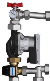
Kit compacto premontado y listo para instalar, compuesto de bomba Wilo Para 25/6 SC\* con conexiones 1 1/2" y longitud de montaje 130 mm, válvula de 3 vías con cabezal termostático, limitador de temperatura máxima de seguridad precableado con la bomba, válvula de bola con termómetro en la impulsión y conexiones 1" (colectores de ida y retorno).
