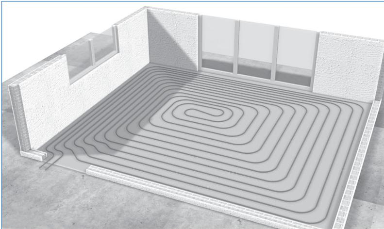
Se utiliza en el sistema de panel liso, tetones y construcción seca. Los tubos se disponen alternando la impulsión y el retorno. De este modo, se consigue una temperatura superficial prácticamente constante en todo el circuito.
